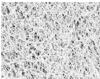
Velo de fibra de vidrio "non woven" clase E indicado para obtener paredes lisas de alta calidad en interiores evitando su fisuración. Refuerzo de paramentos y calidades de pintura (estuco, lacados, etc.)
